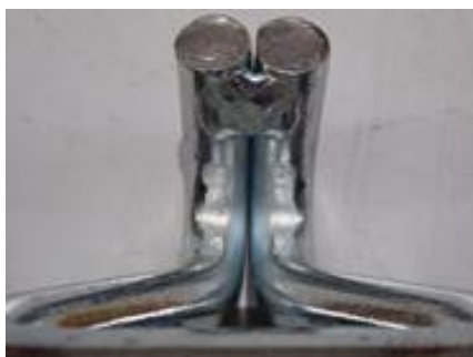
Abb. 21: Verschleiß im Hakengrund
