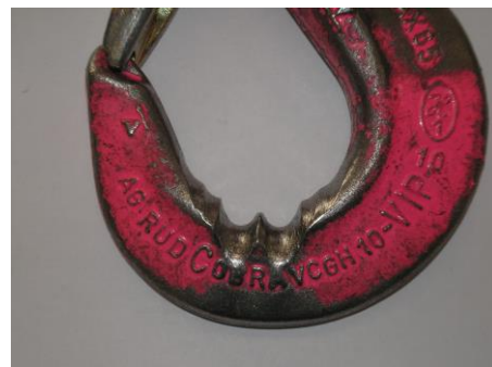
Abb. 20: Verschleiß im Hakengrund
