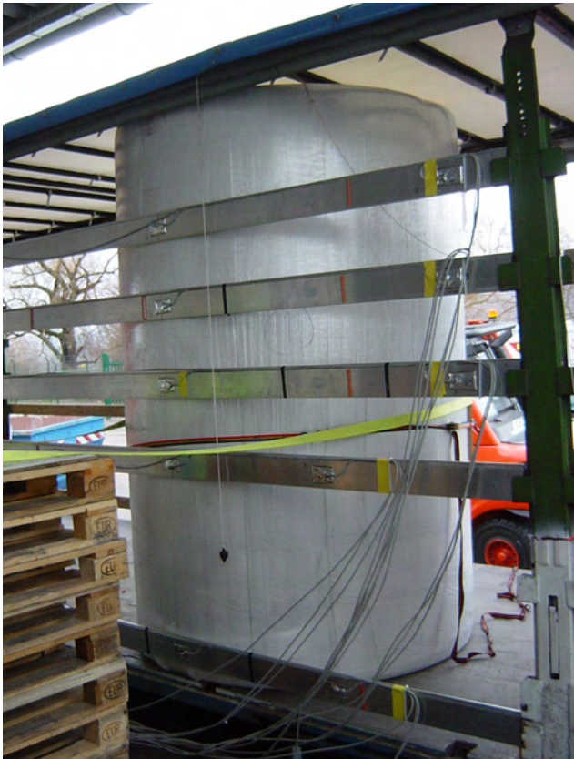
Bild 2.4: Messanordnung mit 5 Einstecklatten [5]
