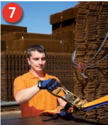
7 Die hier orange abgebildeten Gurte werden quer an Zurrpunkten befestigt und handfest vorgespannt. Sie sichern gegen seitliches Verrutschen.
